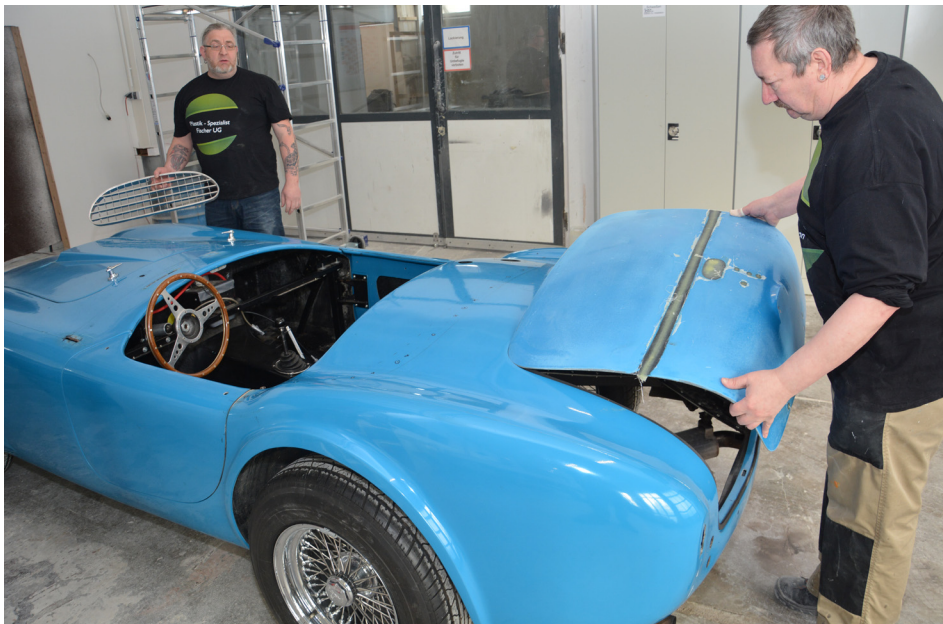
Stefan Fischer (links) und sein Mitarbeiter Allan Moreton stehen an einer Cobra, die sie von Rechts- auf Linkslenker umgebaut haben. Heckklappe und die gesamte Kontur wurden verändert.
