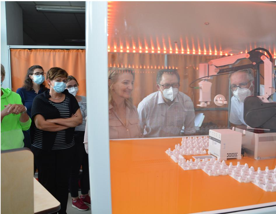
Der Roboter hat den Teststreifen aus dem Eingabeschlitz genommen und schiebt ihn gleich in das weiße Testgerät hinein. Dabei wird er beobachtet von den DRK-Mitarbeitern des Testzentrums (links) sowie (von rechts) Thomas Stoch, Jens Uphoff und Karima Berrahou, die den Ablauf erklärte.
